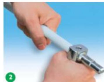
2. Вставьте в трубу калибратор соответствующий номинальному внутреннему диаметру трубы до упора и произведите 1-2 оборота вокруг оси. Откалибруйте трубу для придания ей круглой формы, что облегчит монтаж фитинга.
