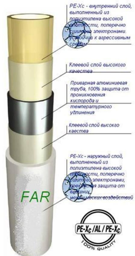
Сшитый полиэтилен типа С получается в результате физического процесса под воздействием радиации типа  $\gamma$  (облучение гамма- лучами) или типа  $\beta$  (облучения электронами). В металлопластиковой трубе FAR для внутреннего и внешнего слоя используется электронный метод.
