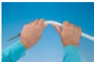
Изгиб при помощи внутренней спиральной пружины
