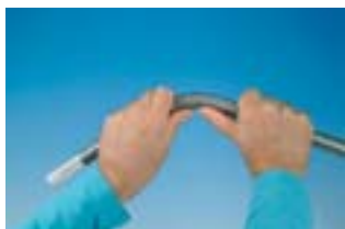
Изгиб при помощи внешней спиральной пружины
